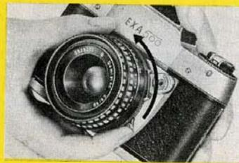
3. Objektiv (1) auswechseln: Arretierhebel (18) zum Objektiv hin drücken. Objektiv nach links drehen, bis sich die roten Punkte (2 und 7) gegenüberstehen. Objektiv nach vorn abnehmen. – Beim Einsetzen umgekehrt verfahren: Rote Punkte gegenüberstellen, Objektiv bis zum Einrasten nach rechts drehen. – Spezialobjektive von den kürzesten bis zu den längsten Brennweiten verwendbar.
