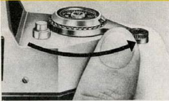
1. Verschußspannen und Filmtransport mit dem Spannhebel (11). Diesen Hebel nach dem Auslösen stets in einem Zuge bis zum festen Anschlag schwenken und zurückgehen lassen.
